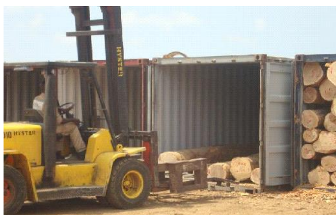
Photo 7. L'empotage des grumes de gmelina se fait à l'aide des charriots élévateurs à cause de leur masse
